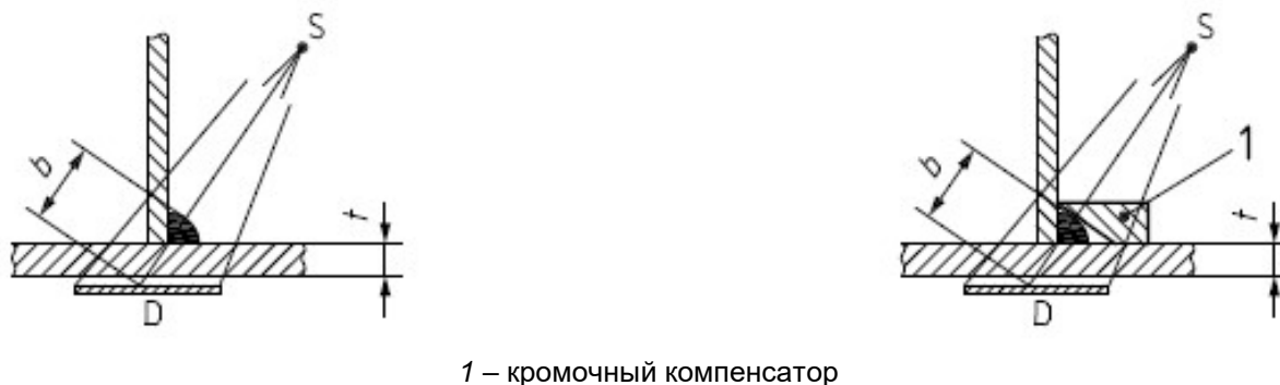
а – Схема контроля без кромочного компенсатора б – Схема контроля с кромочным компенсатором
