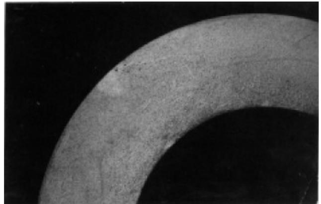
Рисунок А.2 – Недопустимый вид пятнистой ликвации макроструктуры труб из стали марок ШХ15-Ш и ШХ15СГ-Ш
