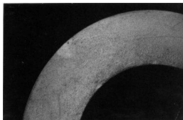
Рисунок А.2 – Недопустимые местные дефекты макроструктуры труб из стали марок ШХ15-Ш и ШХ15СГ-Ш
