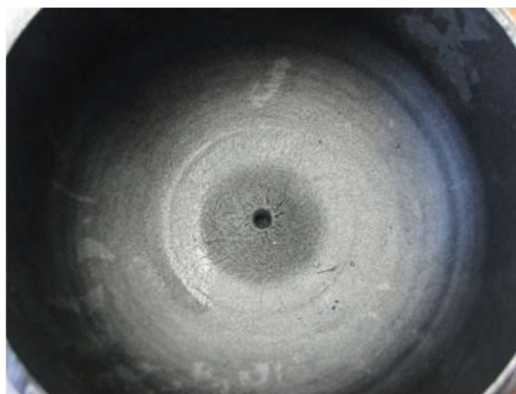
Рисунок А.11 – Возможный дефект в глухом днище баллона, изготовленного из трубной заготовки
