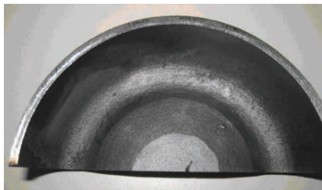
Рисунок А.11 – Возможный дефект в глухом днище баллона, изготовленного из трубной заготовки
