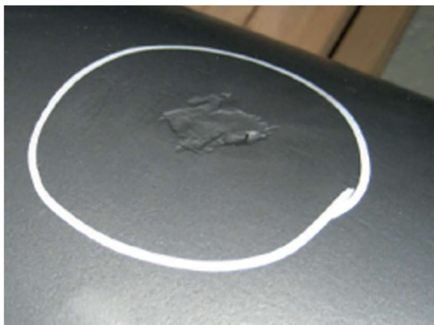
Рисунок А.6 – Местное уменьшение толщины стенки
