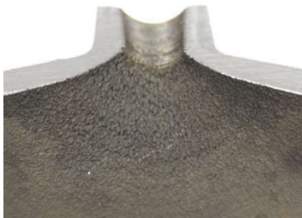
Рисунок А.8 – Несовершенство типа «Рябизна»
