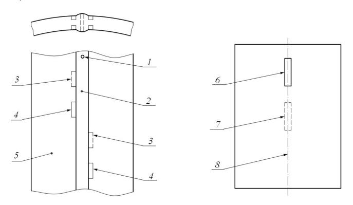
1 – сквозное настроечное отверстие; 2 – сварной шов, полученный дуговой сваркой под флюсом;
