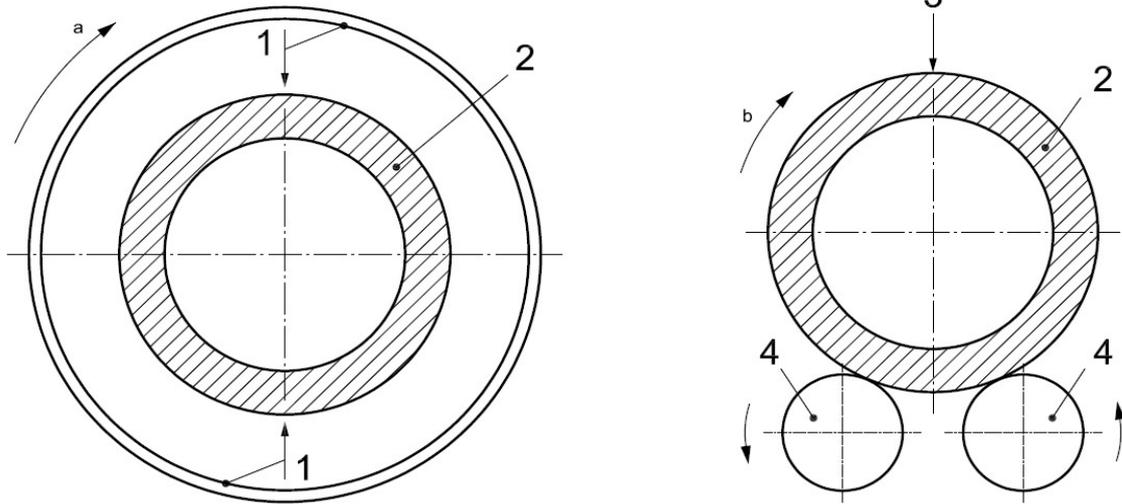
1 – положение преобразователя/дисковой катушки; 2 – труба; 3 – положение неподвижной дисковой катушки; 4 – ролики; а – направление вращения преобразователя; б – направление вращения трубы
