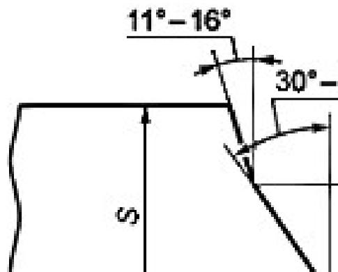
$S$  – толщина стенки трубы;  $B$  – расстояние от внутренней поверхности трубы до точки сопряжения углов скоса фаски
