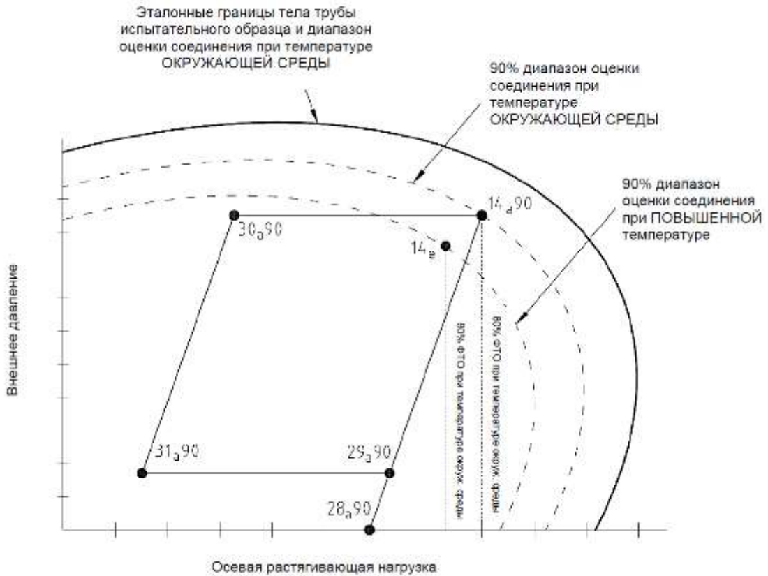
Рисунок ДА.34 – Испытания TS-C – процедура расчета траектории нагружения
