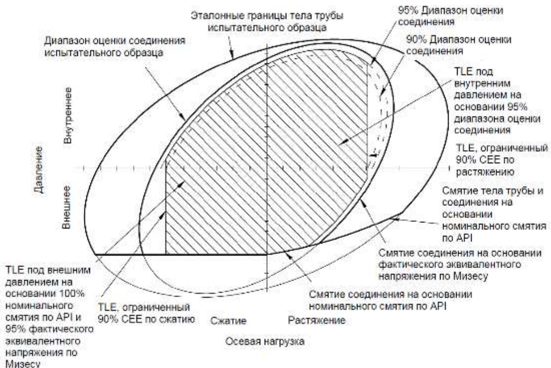
Рисунок ДА.23 – Пример диапазона испытательных нагрузок, где эталонные границы тела трубы и диапазон оценки резьбового соединения не совпадают, и TLE на основании 95 % CEE для внутреннего давления и комбинации 100 % номинального смятия по API и 95 % фактического эквивалентного напряжения по фон Мизесу для наружного давления
