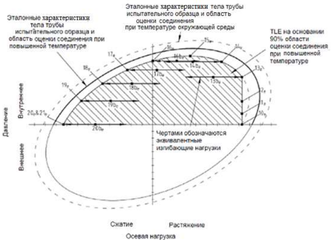
Рисунок 31 – Пример точек нагрузки TS-B при температуре окружающей среды с изгибом при величине нагрузки 90 % от СЕЕ, при совпадении эталонных характеристик тела трубы и области оценки резьбового соединения
