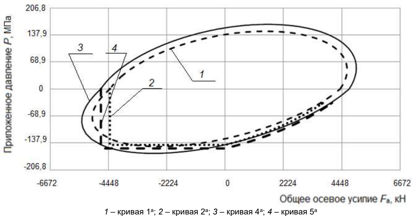
Рисунок D.36 – Эталонные кривые испытательного образца тела трубы (кривые 1 а , 2 а , 4 а и 5 а )
