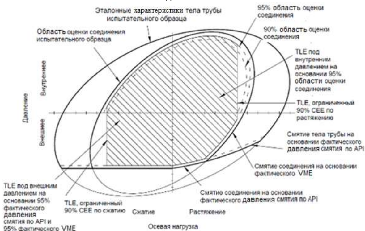
Рисунок 23 – Пример области испытательных нагрузок при несовпадении эталонных характеристик тела трубы и области оценки резьбового соединения, и при TLE, составляющей 95 % от CEE для внутреннего давления и комбинации 100 % от номинального давления смятия по API и 95 % от фактического VME для наружного давления
