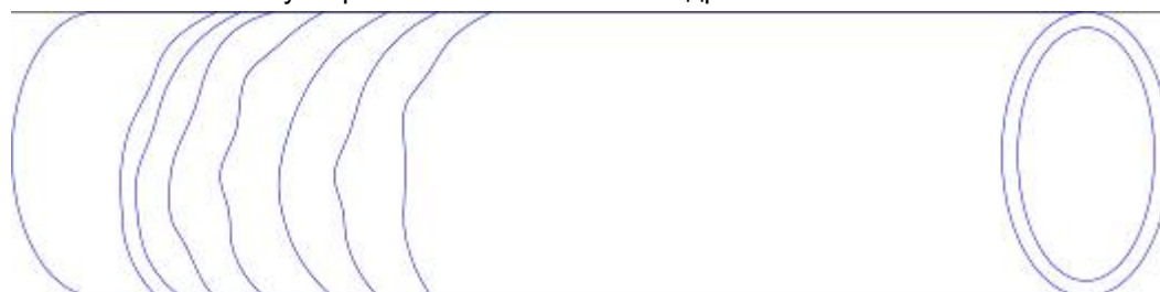
а) подрез по винтовой линии (см. рисунок А.14, приложение А)
