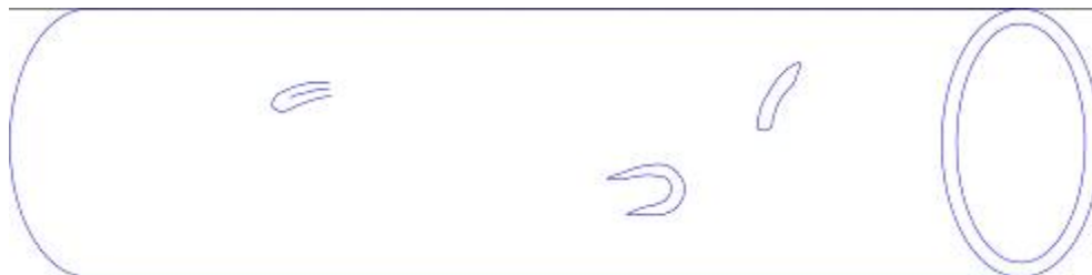
Рисунок 13 – Раскатанные металлические частицы (см. рисунок А.8, приложение А)
