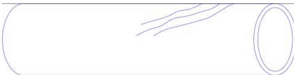
Рисунок 1 – Сталеплавильные плены группового расположения на наружной поверхности, образующиеся при раскатывании поверхностных и подкорковых газовых пузырей слитка и заготовки (см. рисунок А.1, приложение А)
