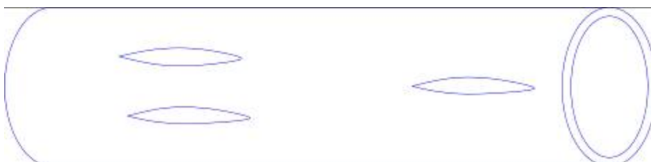
а) ужимы, по телу трубы (см. рисунок А.24, приложение А)
