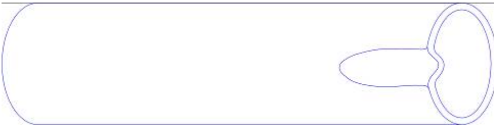
б) вмятина, выходящая на торец (см. рисунок А.41, приложение А)
