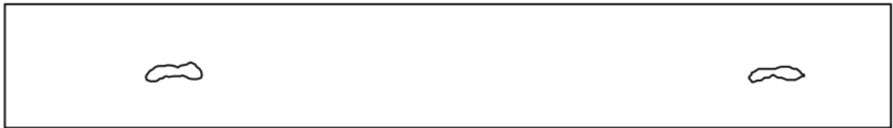
b – пример 2: две несплошности размером 6,0 мм
