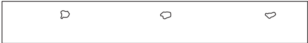
b – пример 2: две несплошности размером 6,0 мм
