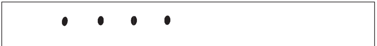
d – пример 4: четыре несплошности размером 1,5мм
