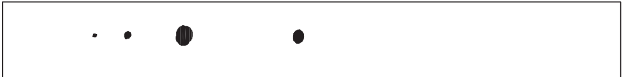
b – пример 2: одна несплошность размером 3,0 мм, одна – 1,5мм, одна – 1,0мм, одна – 0,5мм
