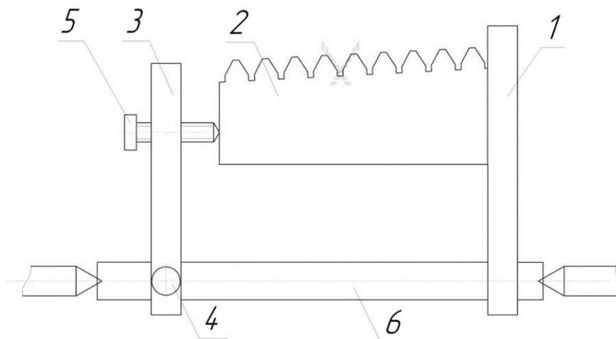
1 – базовая планка; 2 – отливка; 3 – подвижная планка; 4, 5 – винт; 6 – валик
