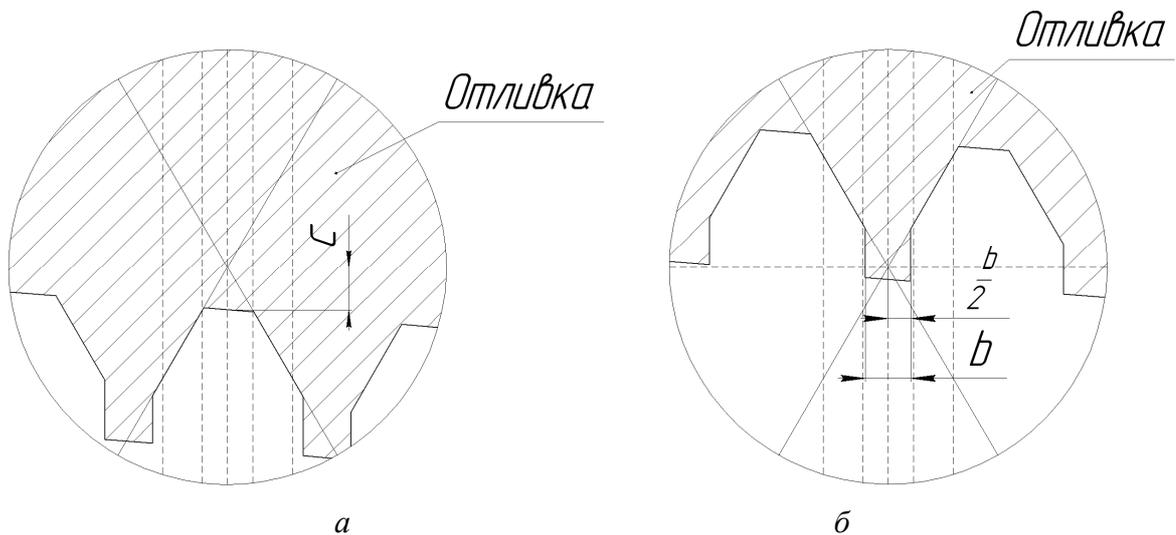
Рисунок 8 – Схемы измерения величины среза вершины, ширины и симметричности канавки треугольного профиля резьбы
