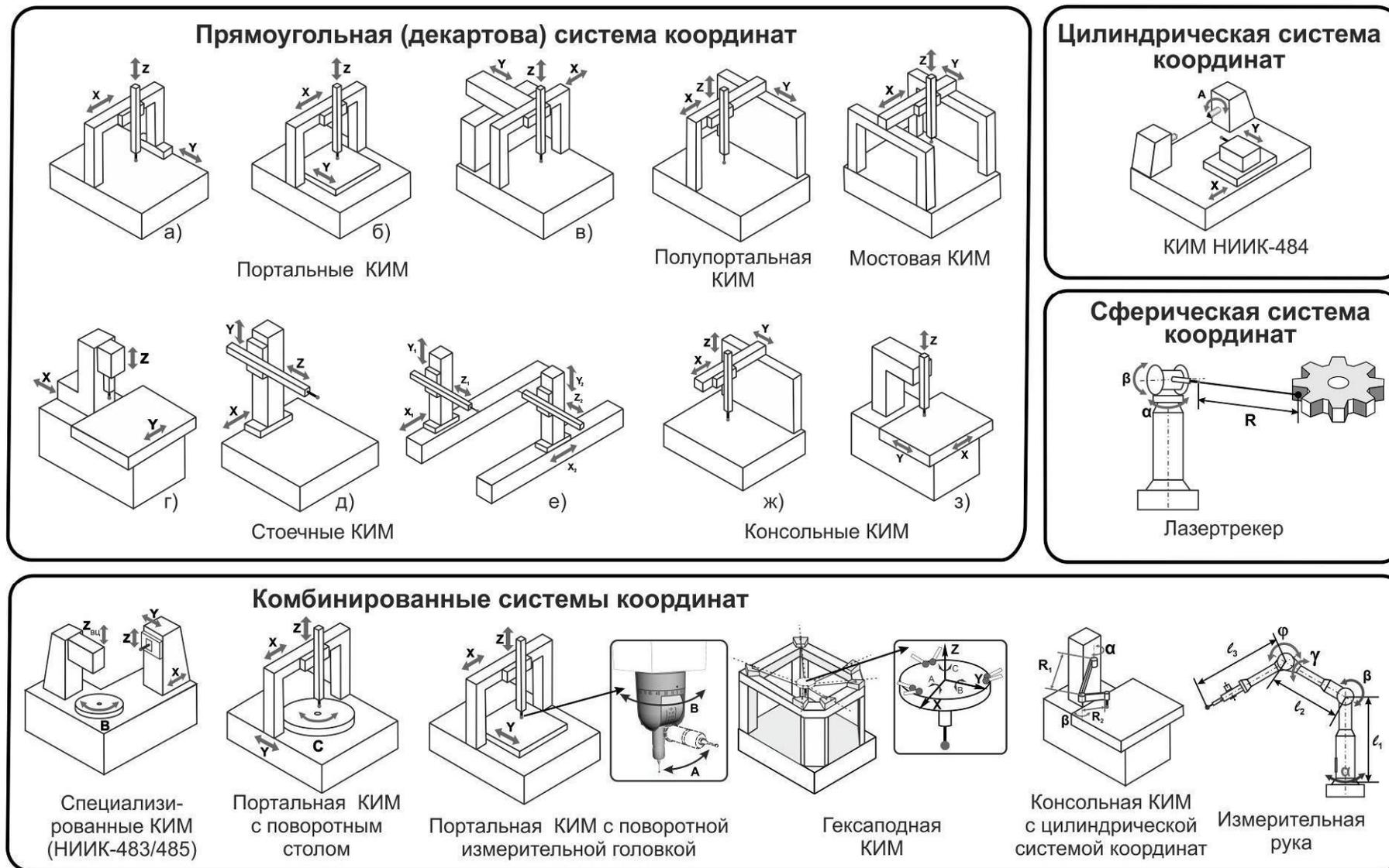
Рисунок А.1 – Типовые компоновки и системы координат координатной измерительной техники
