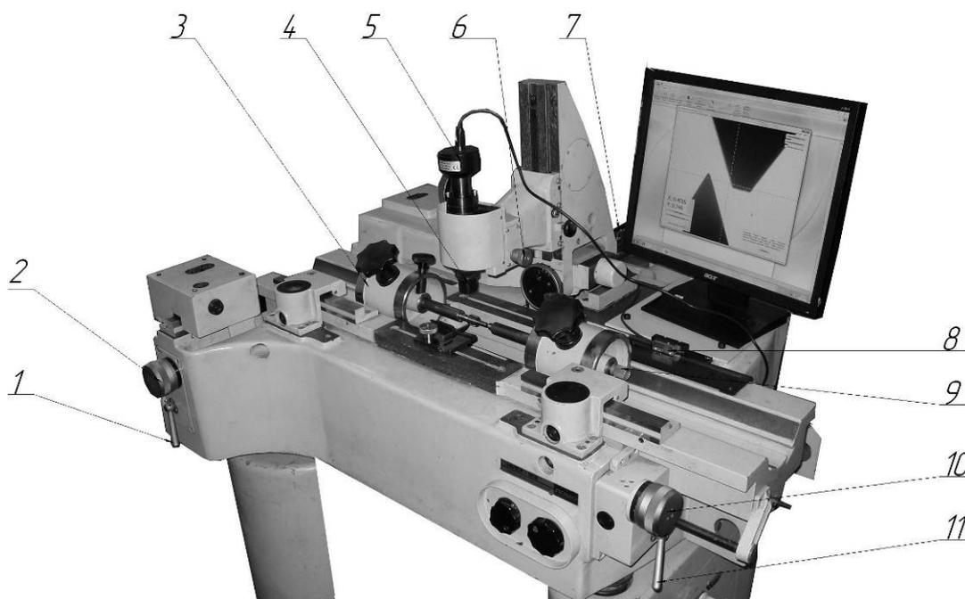
1 – стопор поперечного перемещения; 2 – винт тонкой подачи поперечного перемещения;
