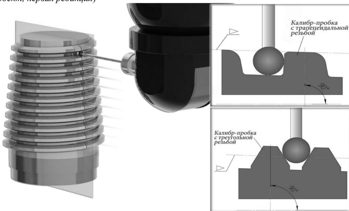
Рисунок 20 – Упрощенный метод измерения
