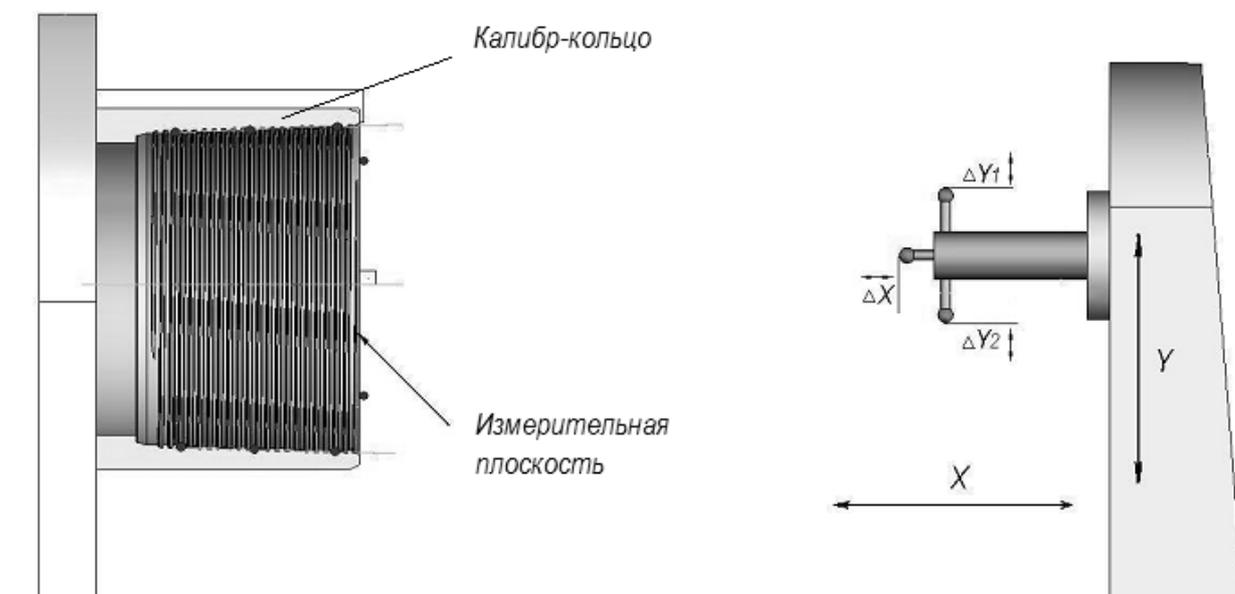
Рисунок В.3 – Схема координатных перемещений на приборе 481КМ2
