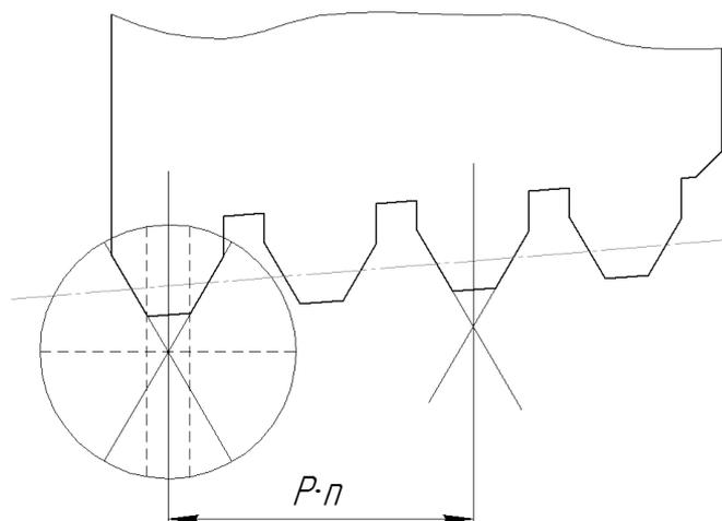
Рисунок 5 – Схема измерения шага резьбы с треугольным профилем на микроскопе теневым методом
