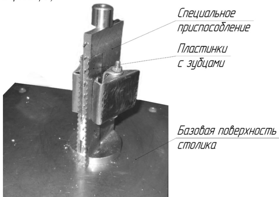
Рисунок Е.2 – Конструкция установки приспособления при заливке
