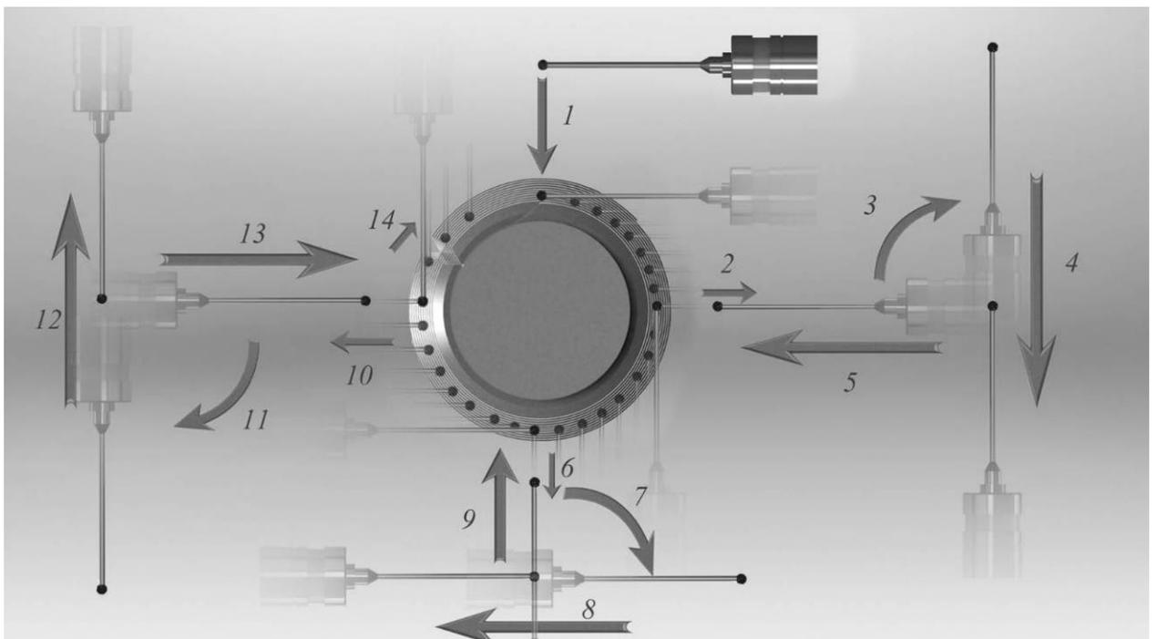
Рисунок 25 – Определение положения спирали с использованием поворотной ИГ
