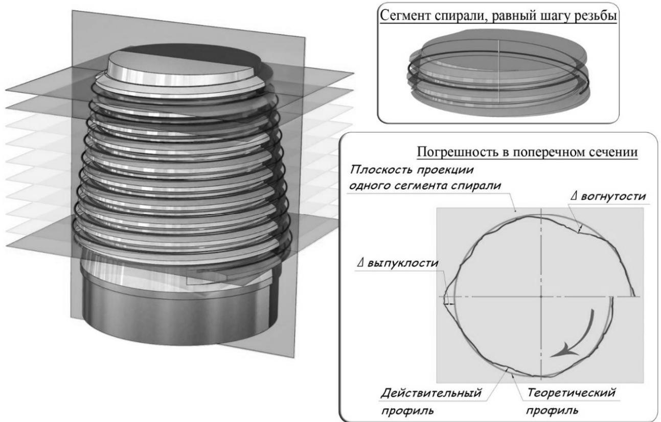
Рисунок 34 – Анализ проекции одного сегмента спирали
