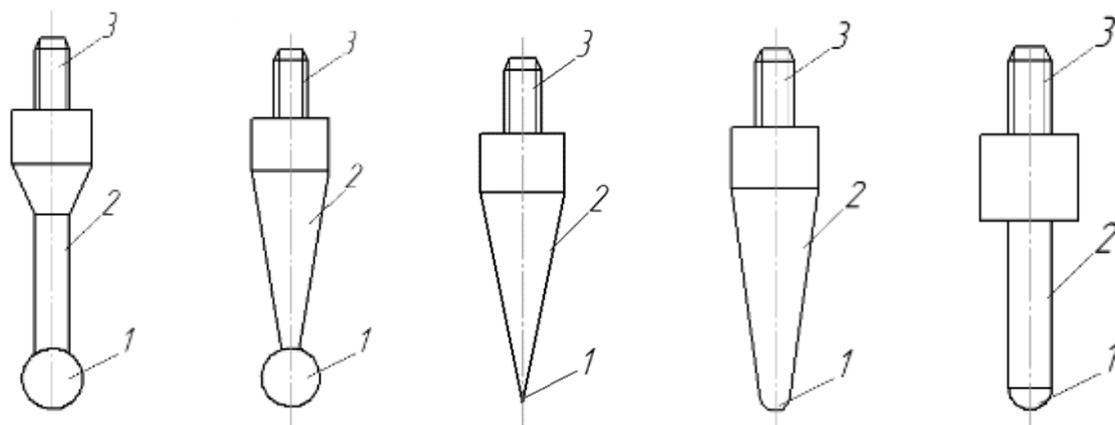
Рисунок А.4 – Варианты конструкций ИН, где 1 – КЭ ИН; 2 – стержень ИН; 3 – крепежный элемент (в зависимости от конструкции ИГ и соединительных элементов может быть резьбовой, гладкий цилиндрический, гладкий цилиндрический с лыской и др.)
