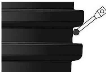
Рисунок 14 – Соприкосновение стержня ИН с измеряемой поверхностью
