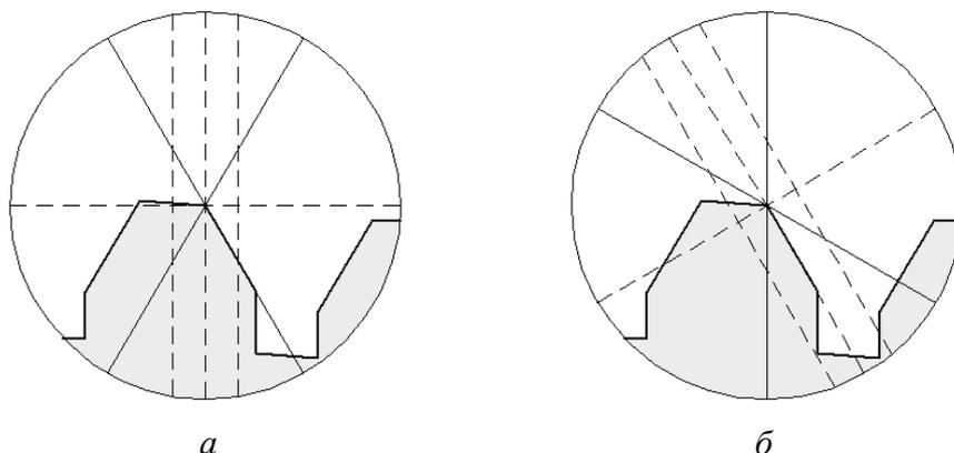
Рисунок 6 – Схема измерения угла наклона боковой стороны профиля
