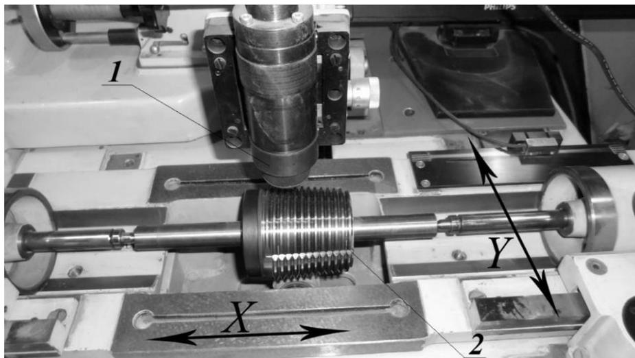
1 – универсальный микроскоп типа УИМ; 2 – измеряемый калибр; X – продольное перемещение;
