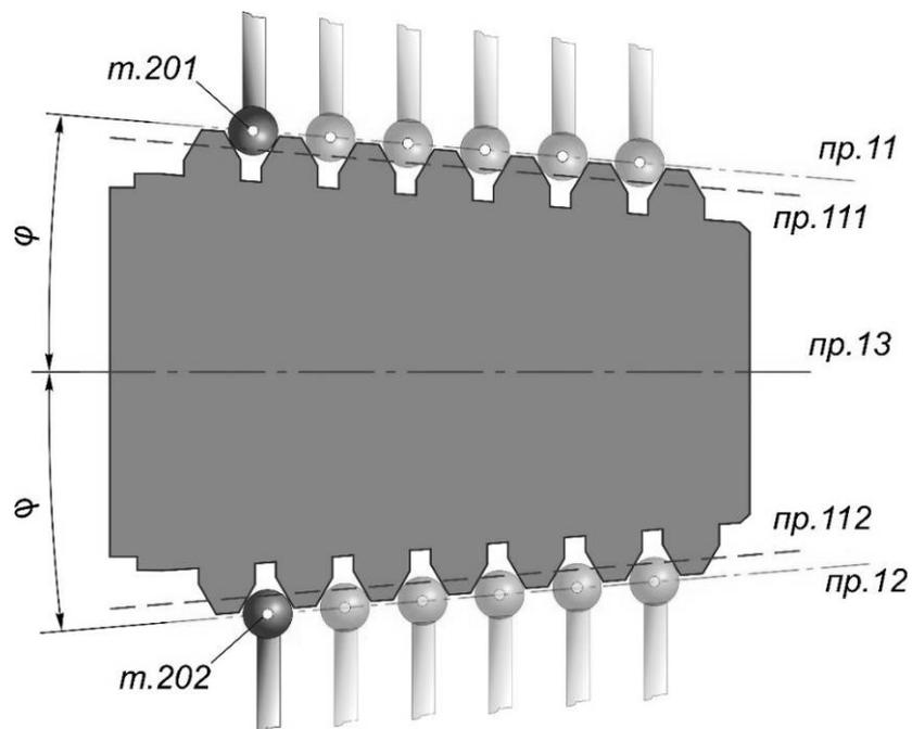
Рисунок 27 – Схема определения оси калибра
