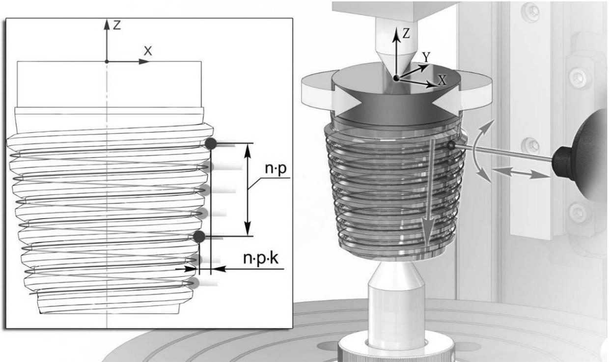
Рисунок 24 – Определение положения спирали с использованием поворотного стола
