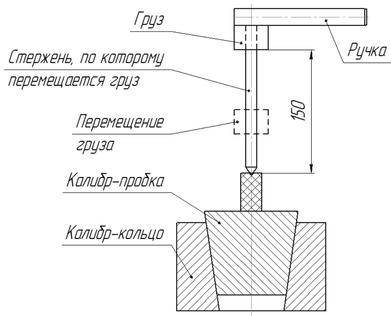
Рисунок П.1 – Специальное приспособление с падающим грузом
