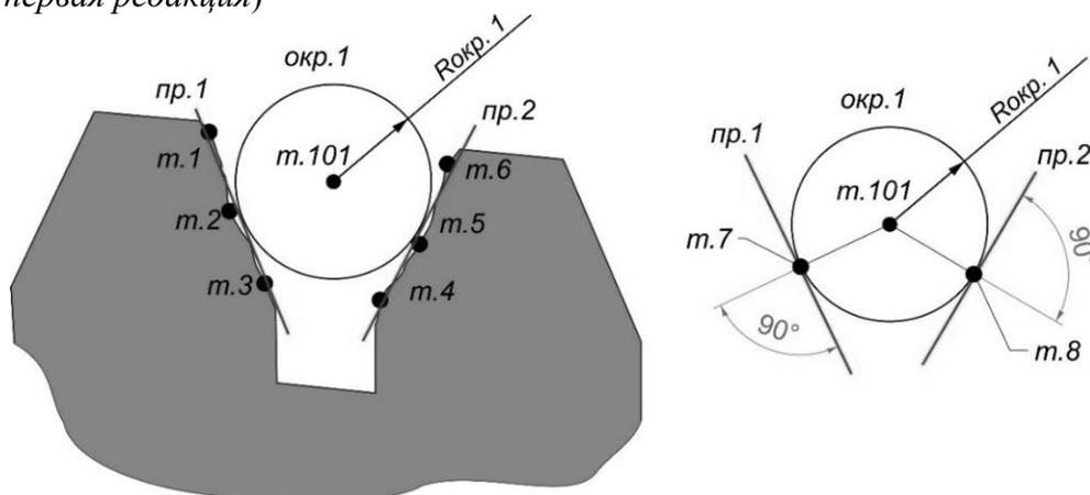
Рисунок 30 – Схема построения вписанной окружности по боковым сторонам профиля
