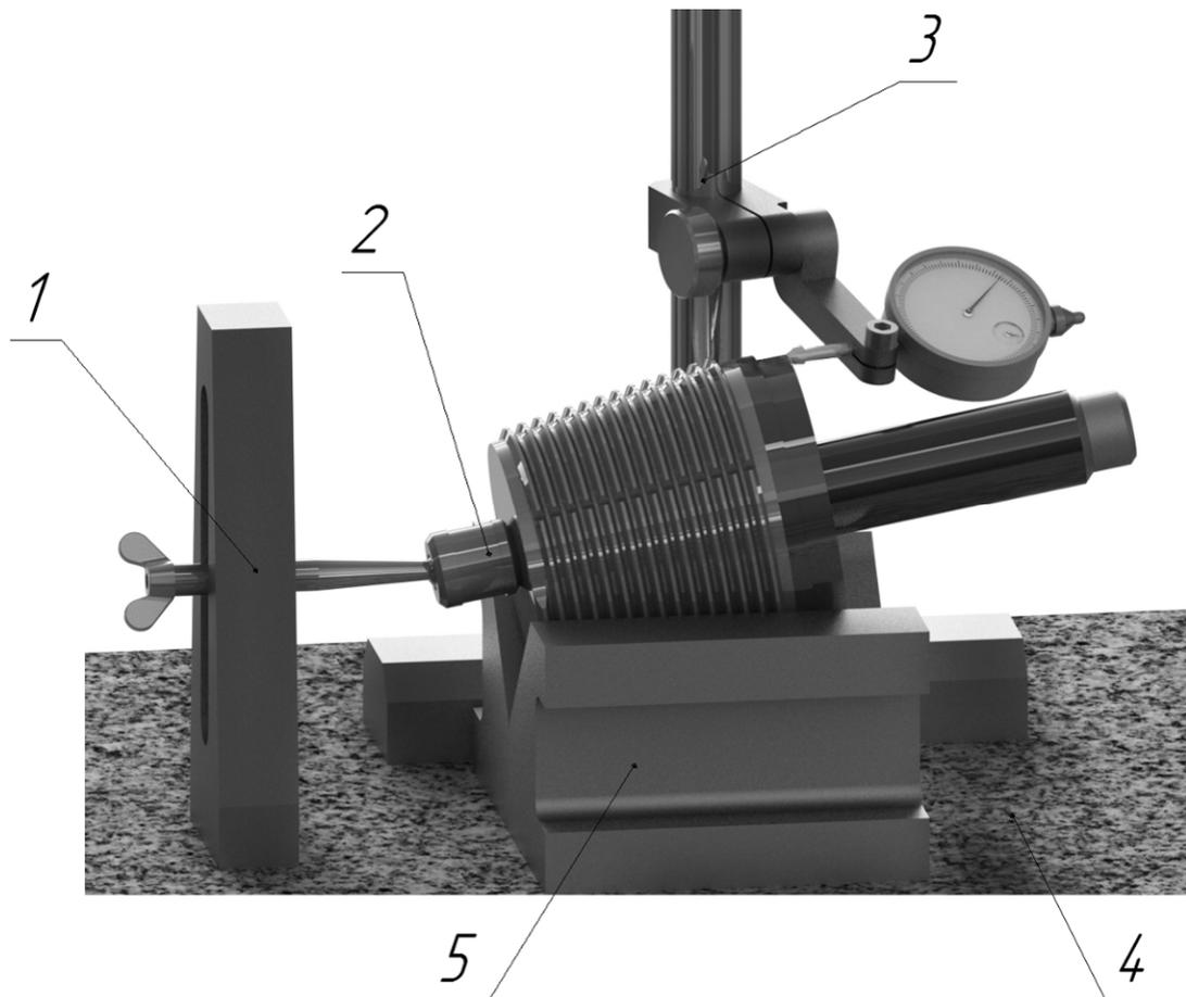
1 – кронштейн; 2 – шарнирная оправка; 3 – стойка с индикатором; 4 – поверочная плита;
