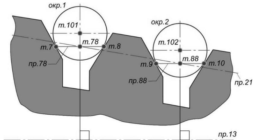
Рисунок 32 – Схема определения средних прямых по вписанным окружностям
