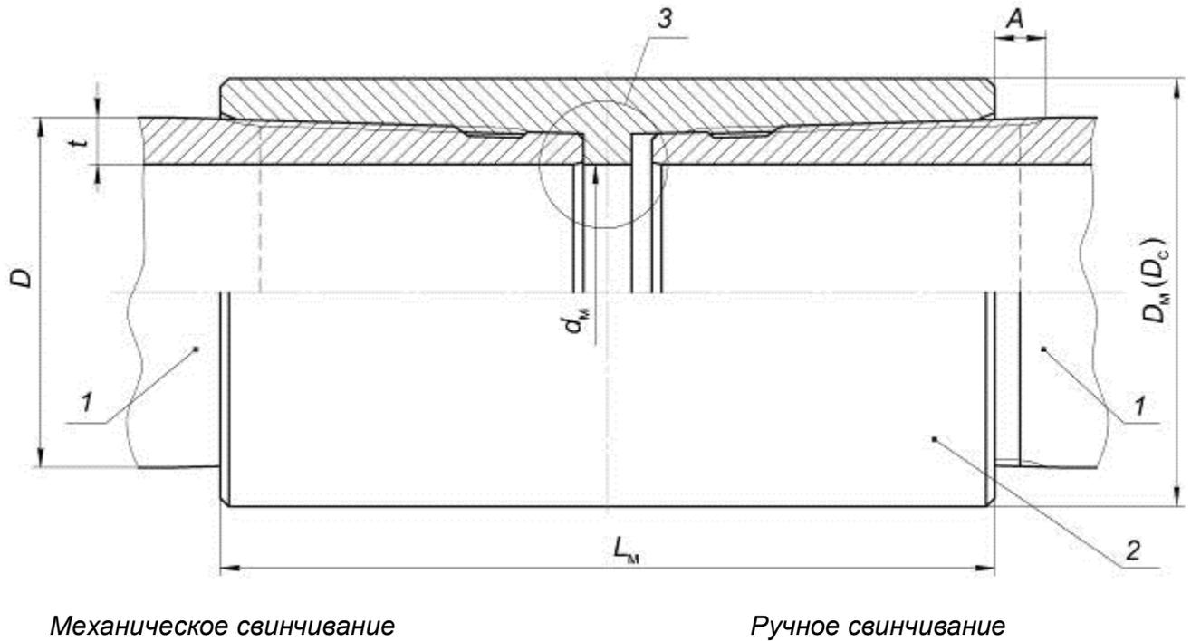
1 – труба; 2 – муфта; 3 – узел уплотнения металл-металл; A – натяг при ручном свинчивании трубы с муфтой; D – наружный диаметр трубы;  $D_M$  – наружный диаметр обычной муфты;  $D_C$  – наружный диаметр специальной муфты;  $d_M$  – внутренний диаметр муфты;  $t$  – толщина стенки трубы;  $L_M$  – длина муфты
