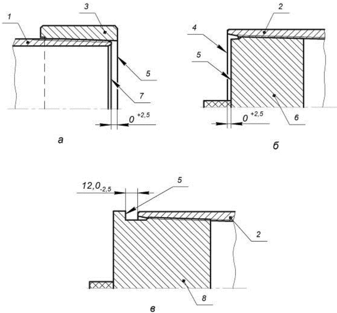
1 – труба; 2 – муфта; 3 – резьбовой и гладкий калибры-кольца; 4 – плоскость торца муфты;
