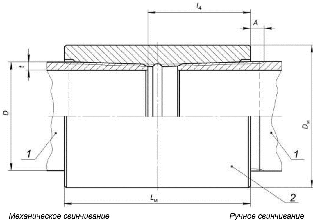
1 – труба; 2 – муфта; A – натяг при ручном свинчивании трубы с муфтой; D – наружный диаметр трубы;  $D_m$  – наружный диаметр муфты;  $L_m$  – длина муфты;  $l_4$  – расстояние от свободного торца муфты до торца трубы внутри муфты;  $t$  – толщина стенки трубы
