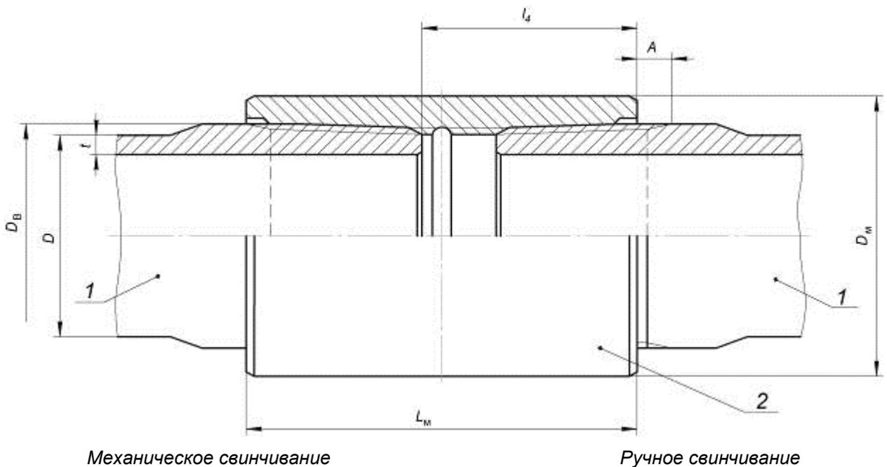
1 – труба; 2 – муфта; A – натяг при ручном свинчивании трубы с муфтой; D – наружный диаметр трубы;  $D_B$  – наружный диаметр высаженного конца трубы;  $D_m$  – наружный диаметр муфты;  $L_m$  – длина муфты;  $l_4$  – расстояние от свободного торца муфты до торца трубы внутри муфты;  $t$  – толщина стенки трубы
