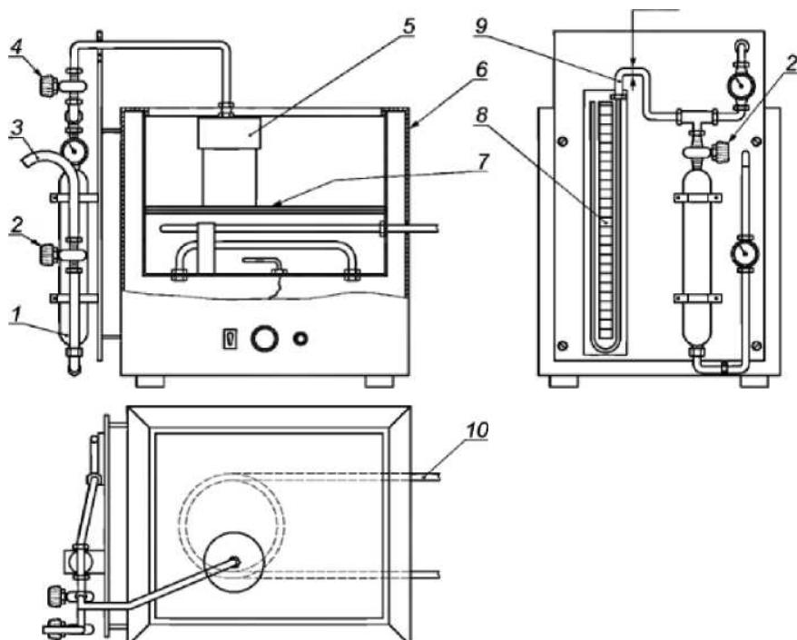
1 — газосборник объемом 250 см<sup>3</sup>, заполненный водой; 2 — вентиль; 3 — трубка для измерения вытесненного объема воды; 4 — вентиль; 5 — автоклав; 6 — ванна с постоянной температурой; 7 — полка; 8 — ртутный манометр 25 см; 9 — трубопровод из нержавеющей стали или полимерного материала; 10 — подвод воды 66°C (см. сноска а к рисунку Н.2)
