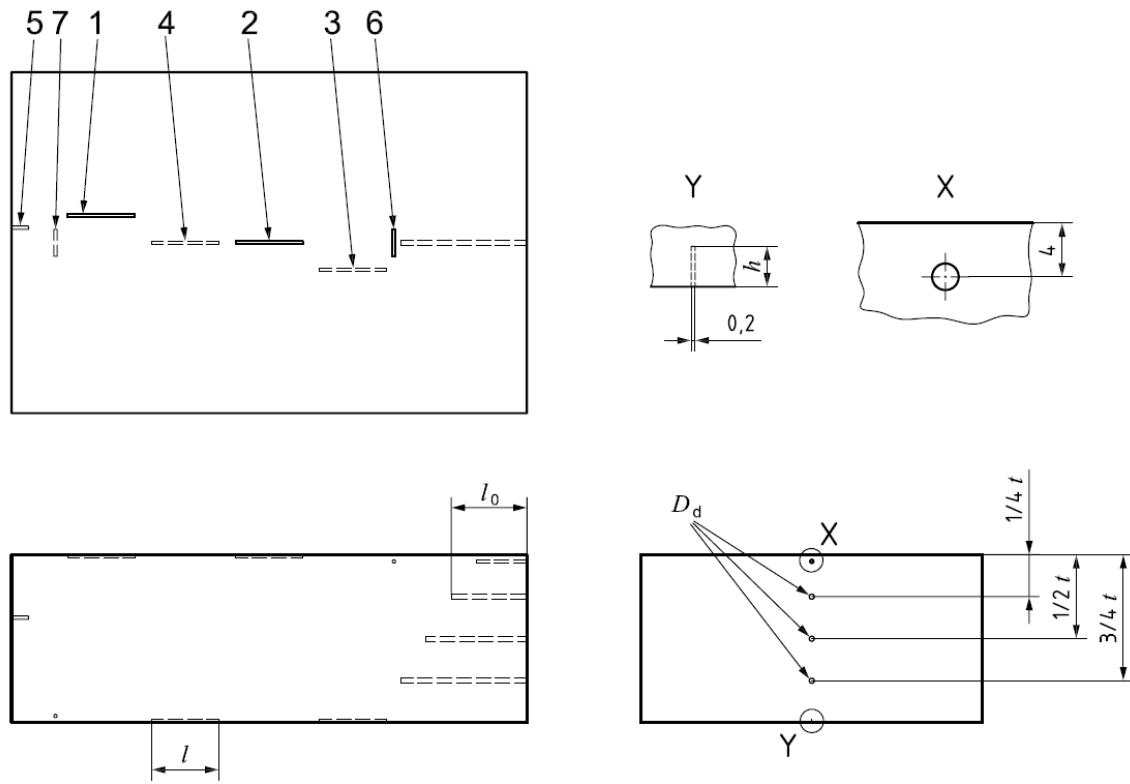
$D_d$  диаметр бокового цилиндрического отверстия
