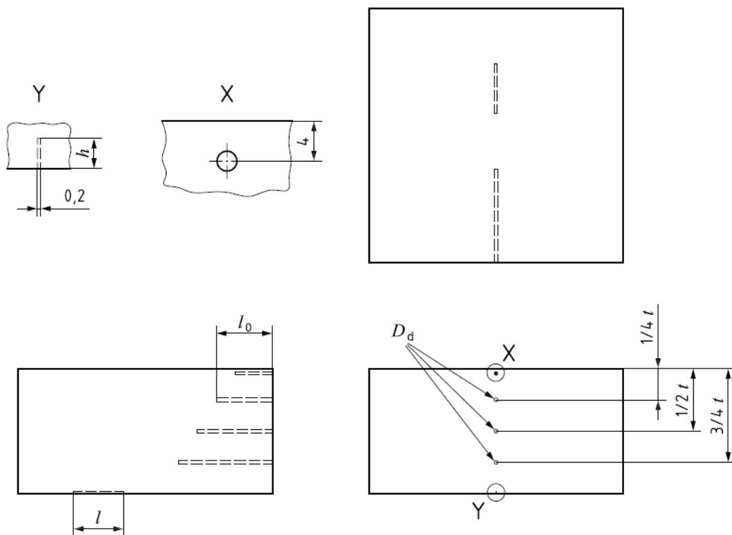
$D_d$  диаметр бокового цилиндрического отверстия
