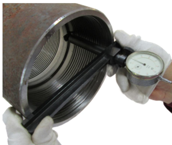
Рисунок 7 – Измерение длины резьбы в муфте при помощи специализированного индикаторного прибора
