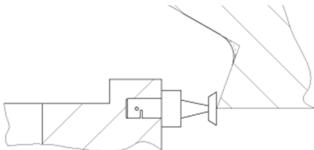
Рисунок 68 – Измерительный наконечник с контактным элементом типа «кнопка»
