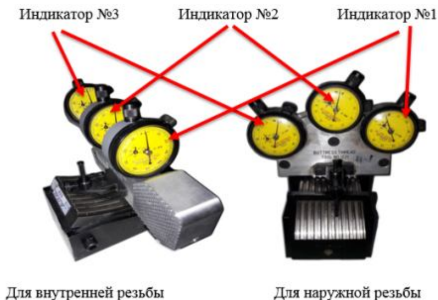
Рисунок 37 – Нулевое положение трехиндикаторного прибора
