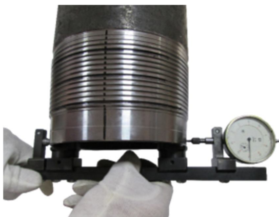
Рисунок 46 – Измерения диаметра уплотнительной поверхности на трубе
