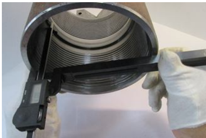
Рисунок 6 – Измерение длины резьбы в муфте при помощи специализированного штангенглубиномера с удлиненной траверсой
