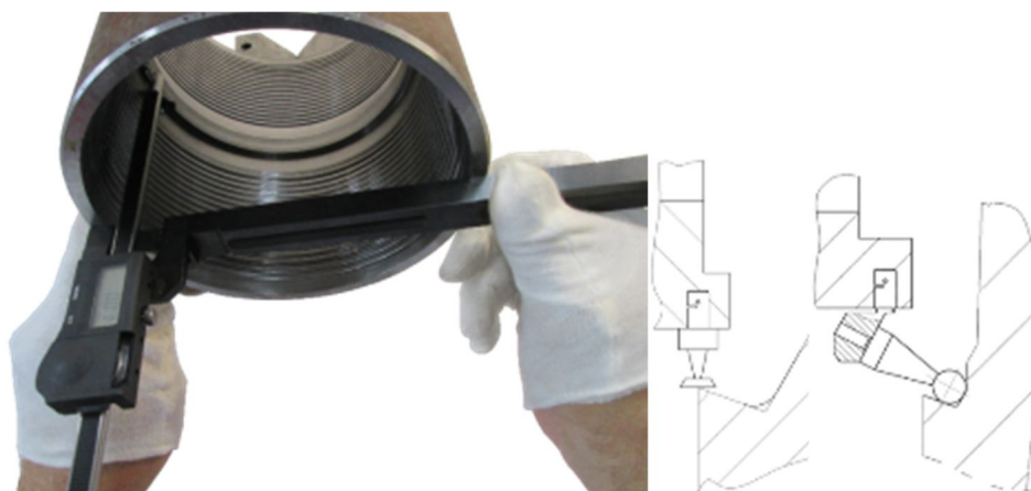
Рисунок 75 – Измерение расстояния от торца муфты до упорного уступа при помощи специализированного оснащенного удлиненной траверсой и цифровым отсчетным устройством штангенглубиномера
