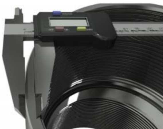
Рисунок 66 – Измерение ширины торцевой плоскости муфты
