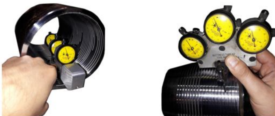
Рисунок 38 – Измерение геометрических параметров профиля резьбы при помощи трехиндикаторного прибора
