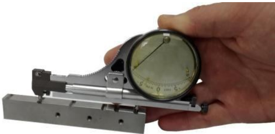
Рисунок 19 – Настройка прибора по шаблону
