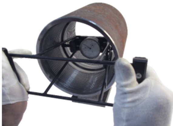
Рисунок 47 – Измерения диаметра уплотнительной поверхности на муфте
