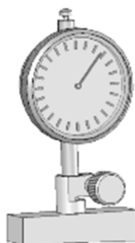
Рисунок 27 – Прибор для измерения высоты профиля резьбы с основанием, опорная поверхность которого изготовлена под углом уклона резьбы \phi
