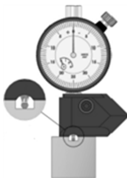
Рисунок 26 – Прибор для измерения высоты профиля резьбы с основанием (опорой) прямого профиля
