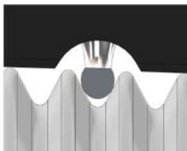
Рисунок 33 – Схема измерения расстояния от вершин резьбы до линии среднего диаметра резьбы с треугольным профилем
