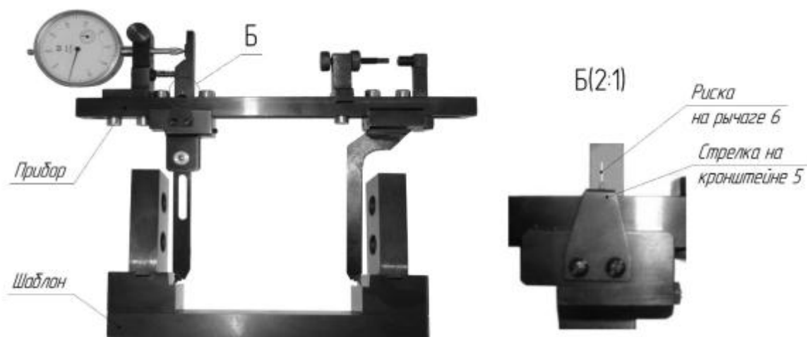
Рисунок Г.10 – Схема настройки индикаторного прибора для измерения диаметра уплотнительной расточки муфты в области упорного уступа по специальному настроечному шаблону
