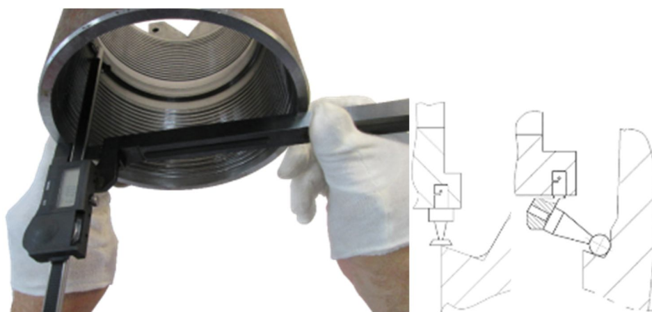
Рисунок 82 – Измерение расстояния от торца муфты до упорного уступа специализированным, оснащенным удлиненной траверсой и цифровым отсчетным устройством, штангенглубиномером
