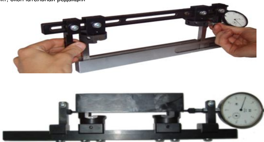
Рисунок Г.3а – Схема настройки индикаторного прибора со ступенчатыми поворотными упорами для измерения диаметра уплотнительной проточки трубы измерительной плоскости по универсальному настройчному шаблону
