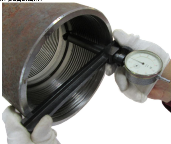
Рисунок 7 – Измерение длины резьбы в муфте специализированным индикаторным прибором
