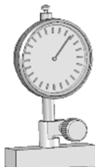
Рисунок 25 – Прибор для измерения высоты профиля резьбы с основанием, опорная поверхность которого изготовлена под углом уклона резьбы \varphi
