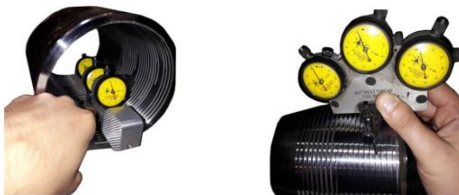
Рисунок 38 – Измерение геометрических параметров профиля резьбы трехиндикаторным прибором
