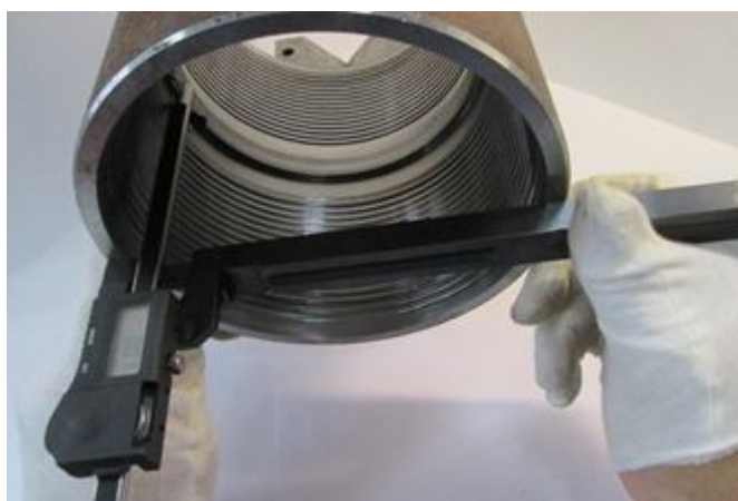
Рисунок 6 – Измерение длины резьбы в муфте специализированным штангенглубиномером с удлиненной траверсой
