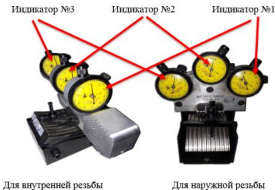
Рисунок 37 – Нулевое положение трехиндикаторного прибора
