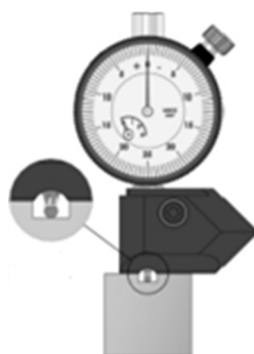
Рисунок 24 – Прибор для измерения высоты профиля резьбы с основанием (опорой) прямого профиля
