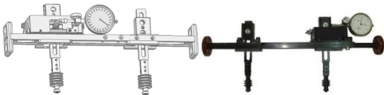
Рисунок 43 – Типовые конструкции индикаторных приборов с КЭ ИН типа «ролик»
