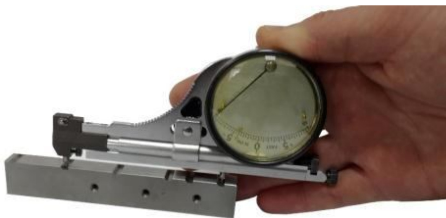
Рисунок 17 – Настройка прибора по шаблону
