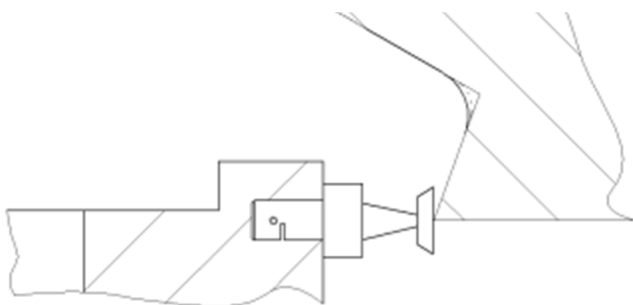
Рисунок 72 – Измерительный наконечник с контактным элементом типа «кнопка»
