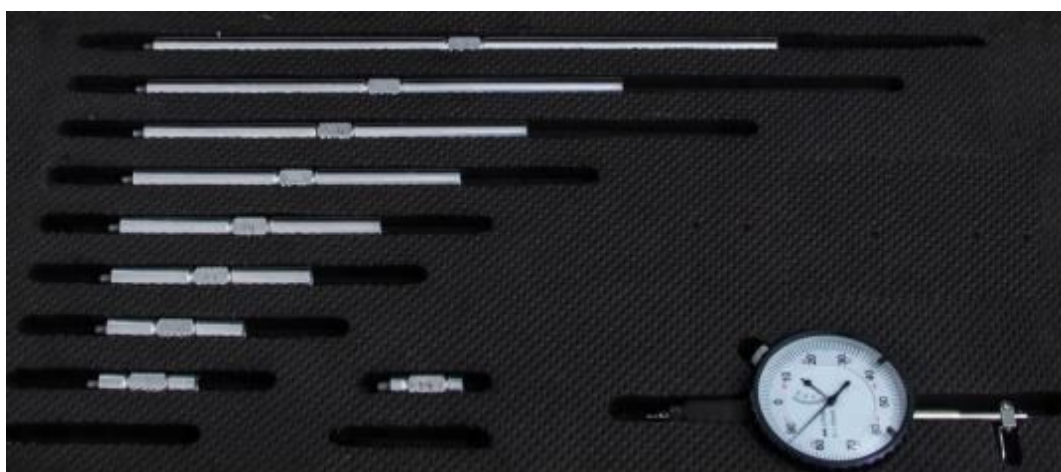
Рисунок 13 – Варианты приборов для измерения разности диаметров (конусности) на муфте
