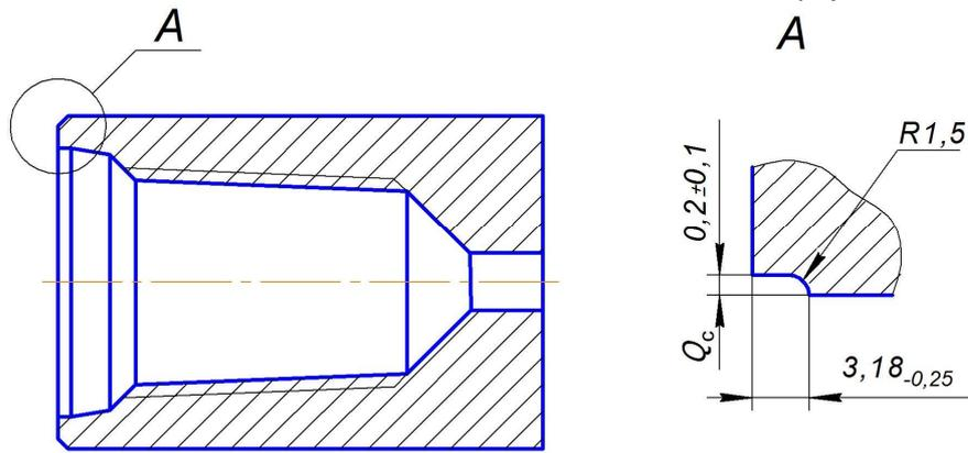
Рисунок 11 – Цилиндрическая контрольная метка на муфтовом конце
