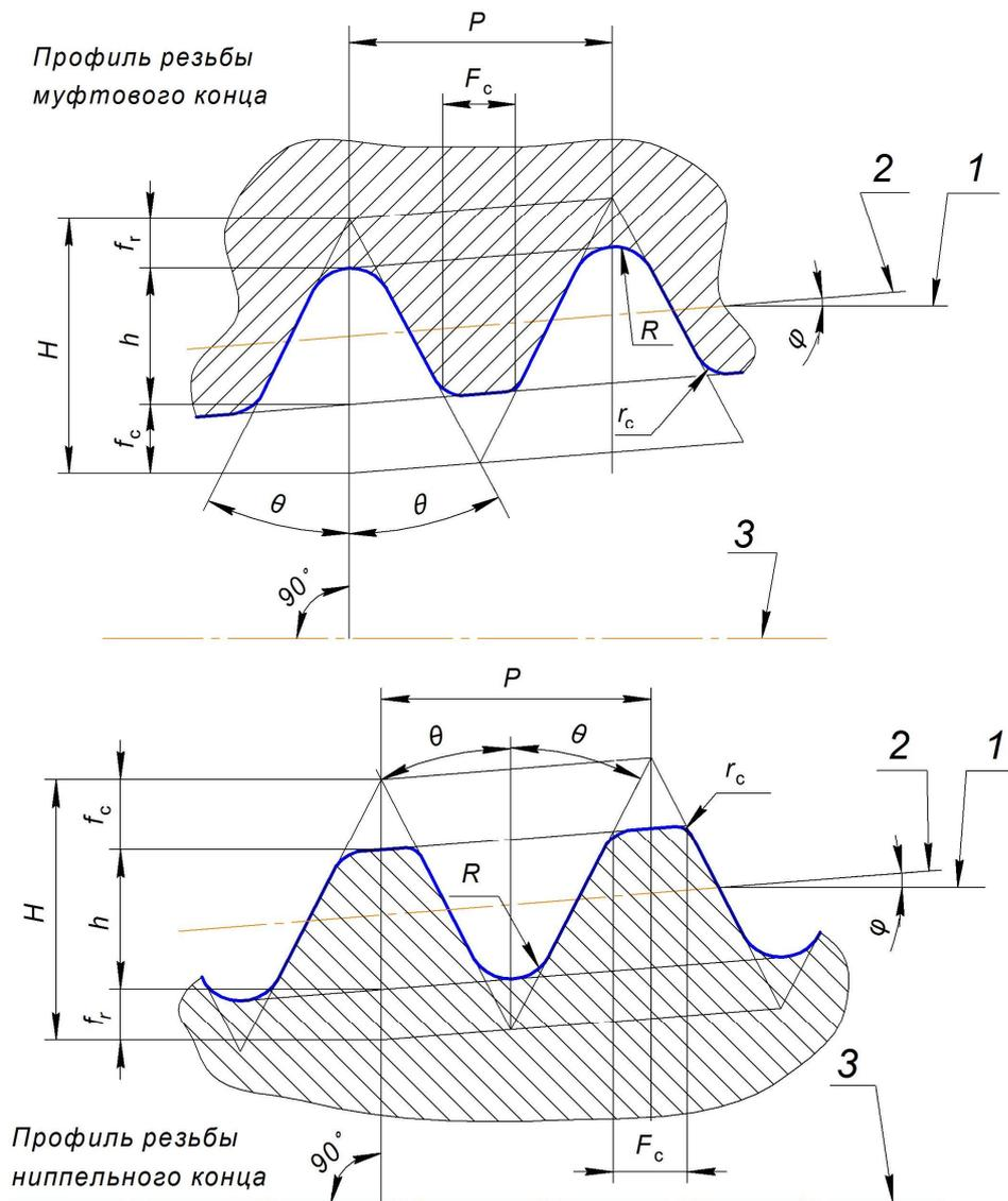
1 – линия, параллельная оси резьбы; 2 – линия среднего диаметра резьбы; 3 – ось резьбы
