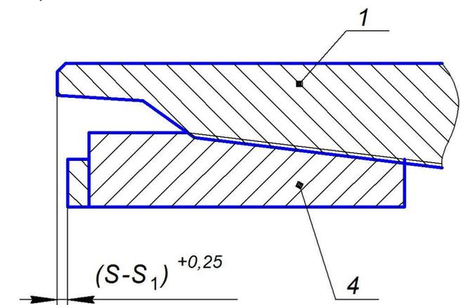
*a – Измерения натяга резьбы муфтового конца*
