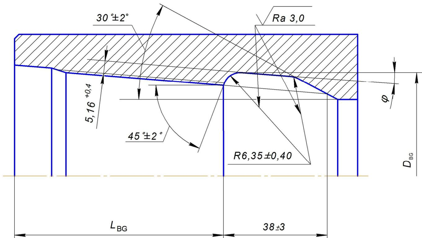
Рисунок 10 – Разгрузочная канавка на муфтовом конце
