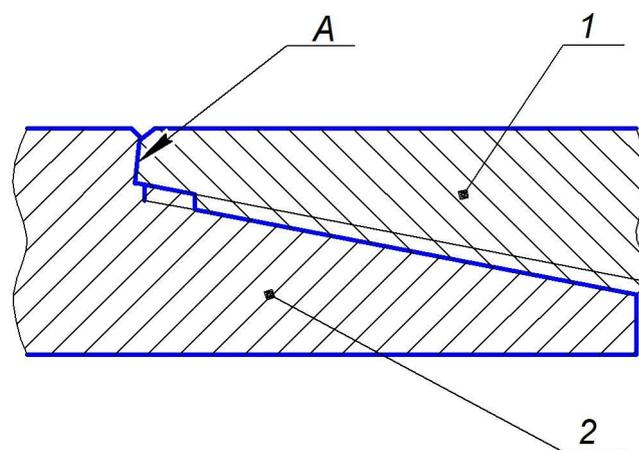
*c – Расположение муфтового и ниппельного концов при ручном свинчивании*
