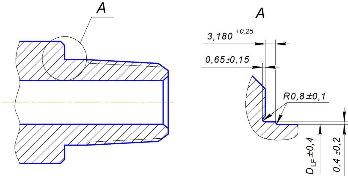
Рисунок 12 – Цилиндрическая контрольная метка на ниппельном конце
