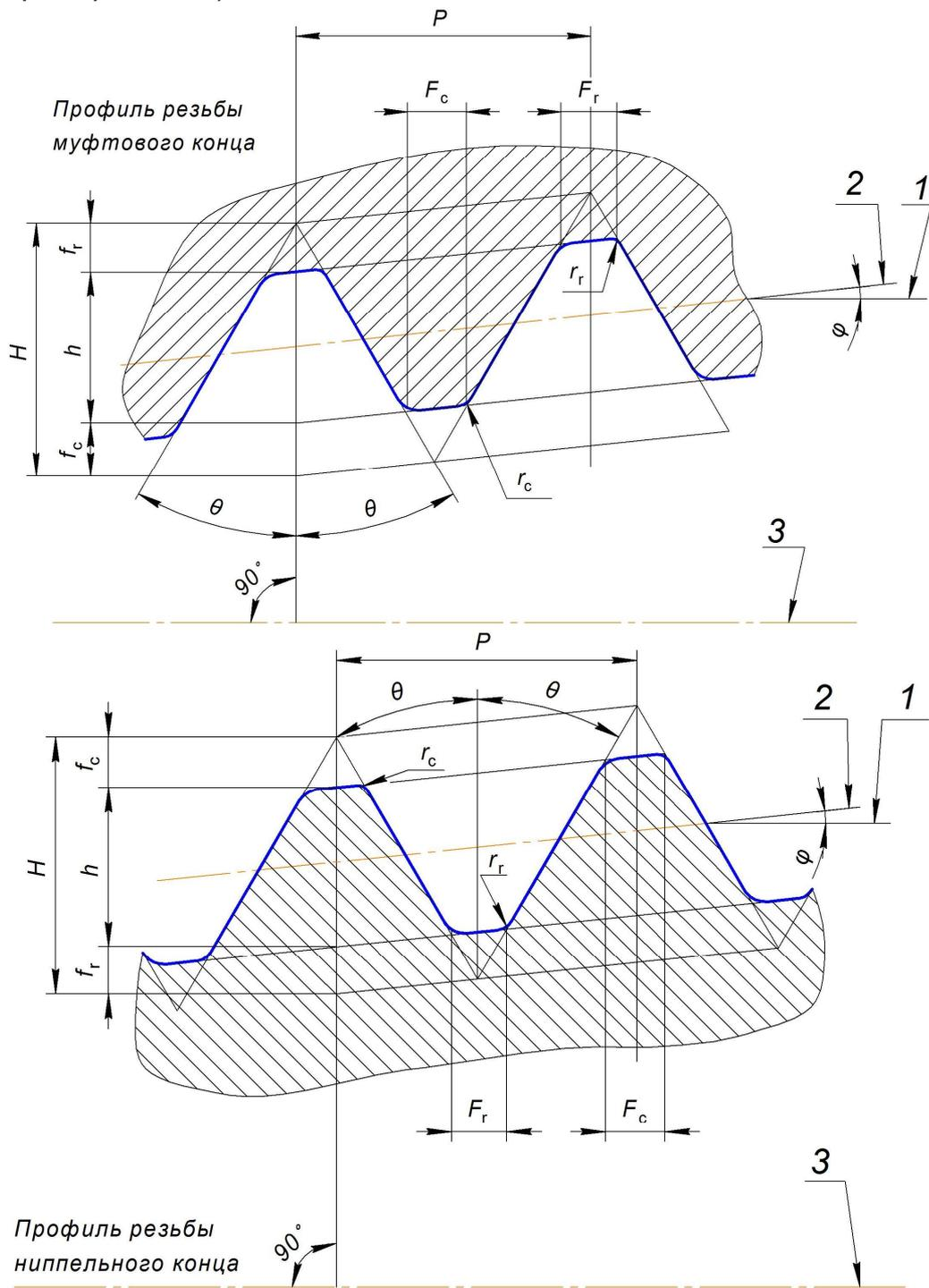
1 – линия, параллельная оси резьбы; 2 – линия среднего диаметра резьбы; 3 – ось резьбы
