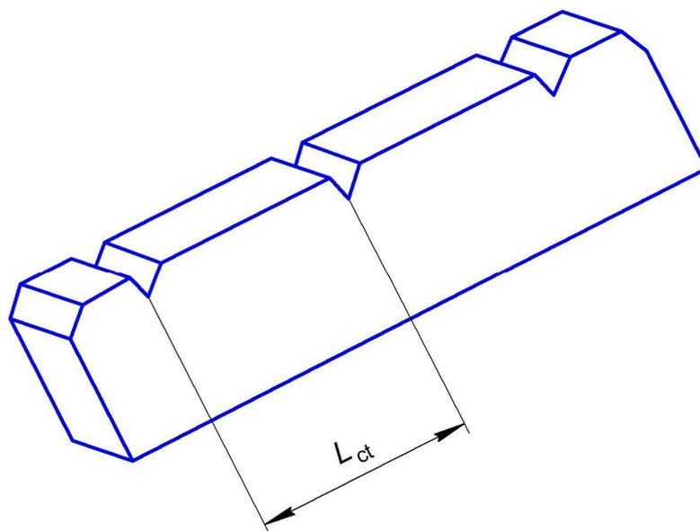
Рисунок 15 – Шаблон для настройки прибора для измерения шага резьбы
