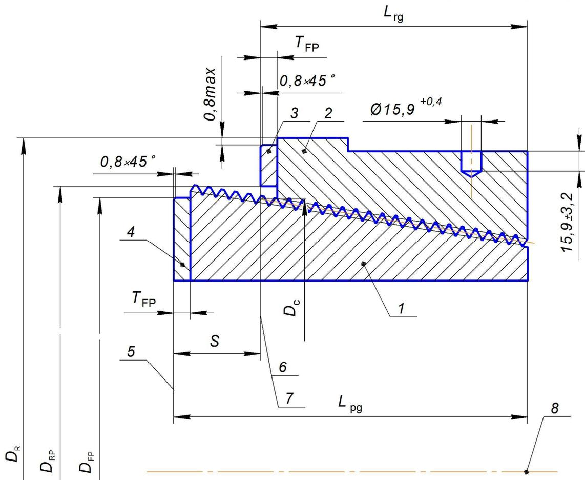
1 – калибр-пробка; 2 – калибр-кольцо; 3, 4 – установочная пластина; 5 – измерительная плоскость калибра пробки, 6 – измерительная плоскость калибра-кольца; 7 – основная плоскость; 8 – ось калибров
