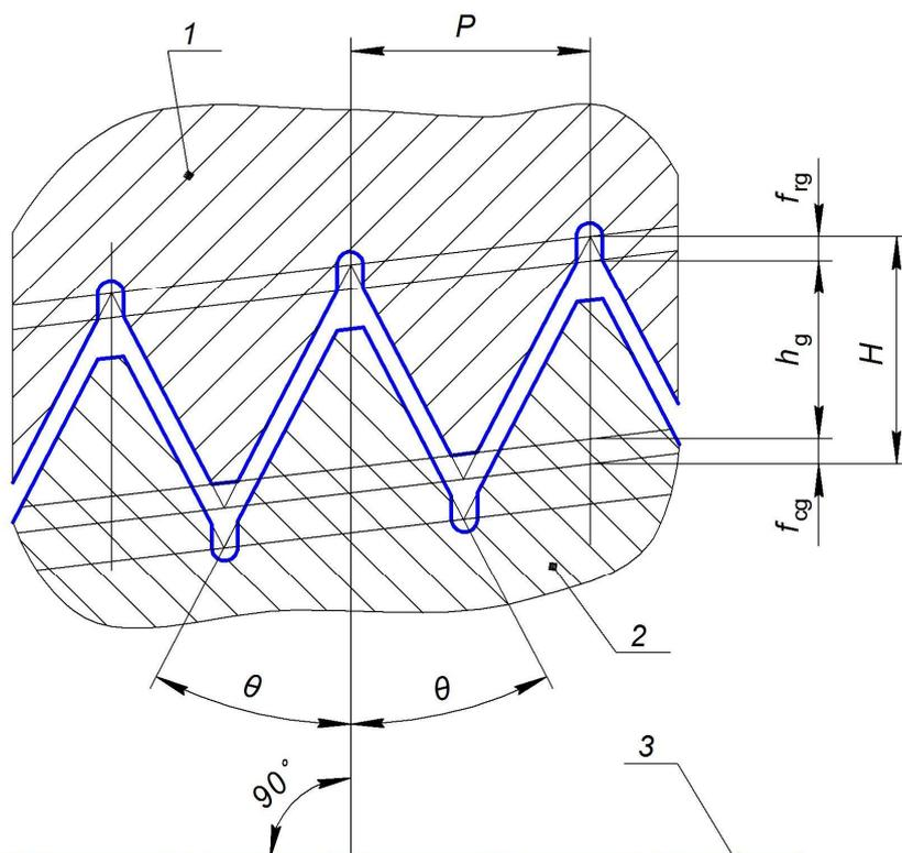
1 – профиль резьбы калибра-кольца; 2 – профиль резьбы калибра-пробки; 3 – ось резьбы
