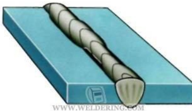
в) Неравномерная ширина шва (схематично)
