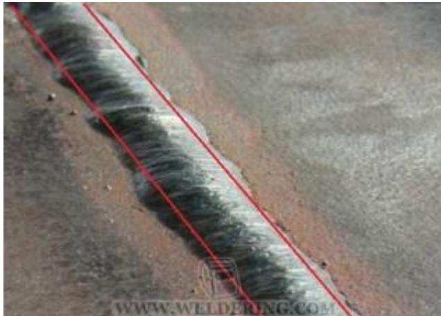
б) Неравномерная ширина шва
