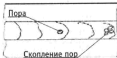
а) Пора в сварном шве (схематично)
