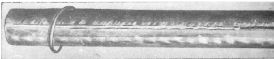
а) Строчечный шов при электросварке сопротивлением
