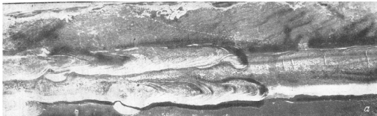
в) Продольные трещины в околошовной зоне (двойные ремонтные швы с трещинами на трубе из стали 17ГС)
