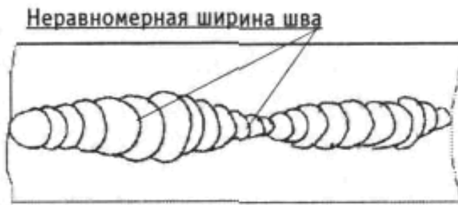
а) Неравномерная ширина шва (схематично)
