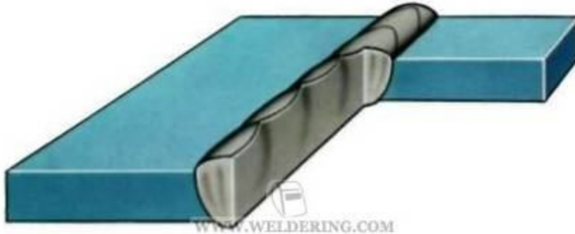
Рисунок 13 – Неравномерная поверхность шва
