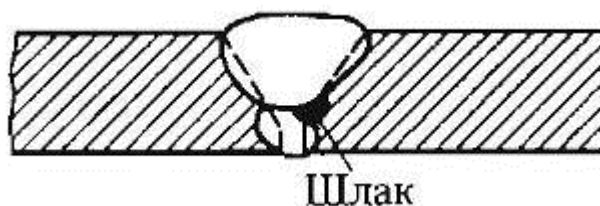
а) Шлаковые включения по подрезу кромки в многослойном шве
