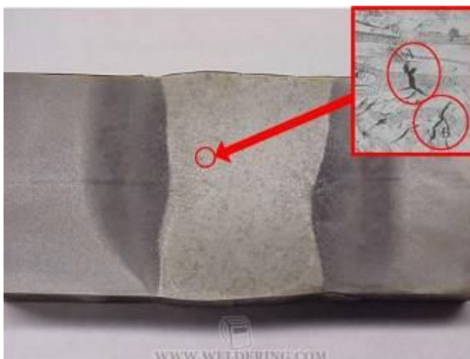
б) Микротрещина сварного соединения
