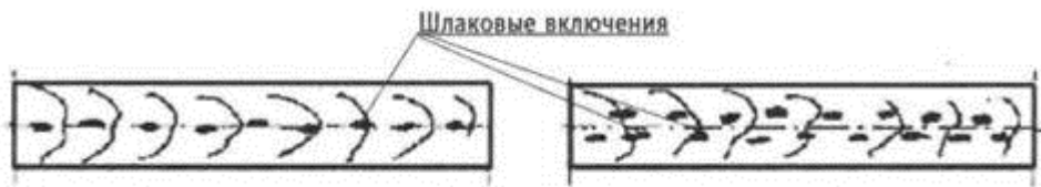
б) Шлаковые включения (схематично)
