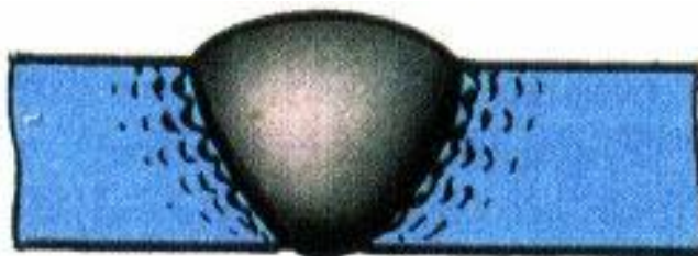
а) Пережог металла (схематично)
