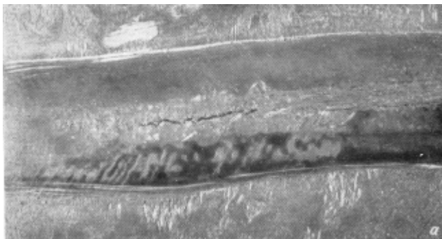
г) Горячая продольная трещина (вершина наружного шва трубы из стали 17ГС)
