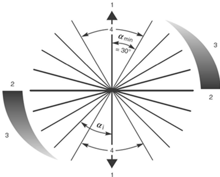
$\alpha$  – угол между направлением магнитного поля и направлением несплошности;  $\alpha_{\min}$  – минимальный угол необходимый для обнаружения несплошности;  $\alpha_i$  – пример ориентации несплошности; 1 – направление магнитного поля; 2 – направление для оптимальной чувствительности обнаружения; 3 – направление, на котором снижается чувствительность обнаружения; 4 – направление, на котором чувствительность обнаружения недостаточная
