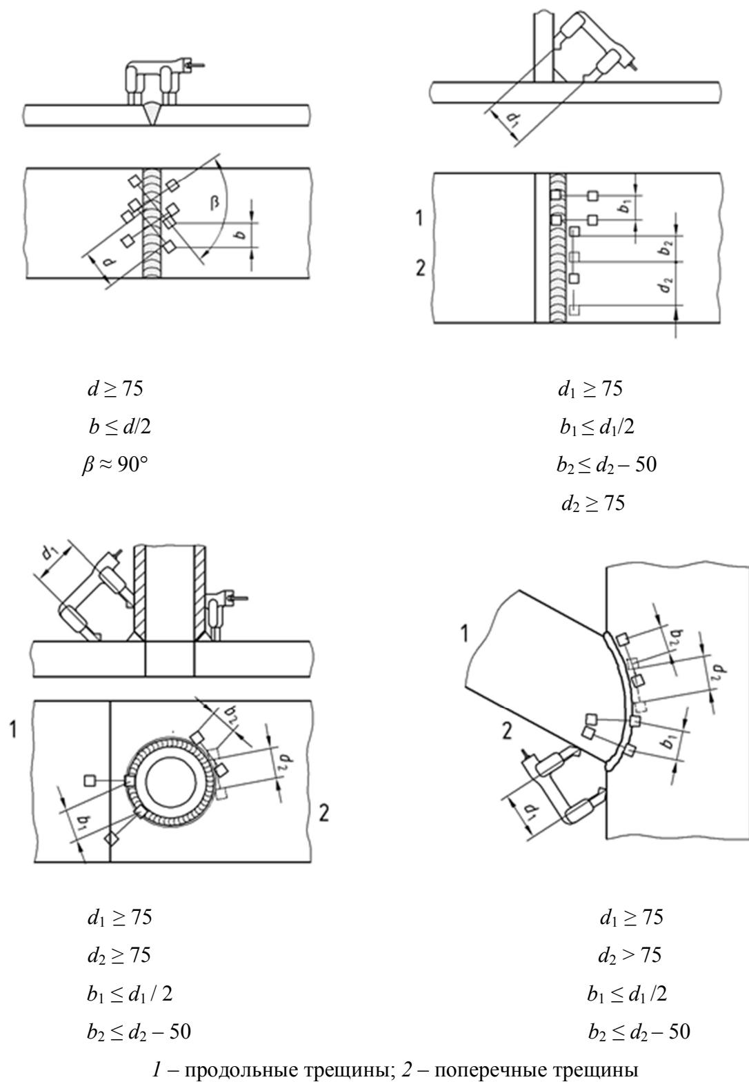
Рисунок 4 – Типовые схемы намагничивания ярмовым электромагнитом
