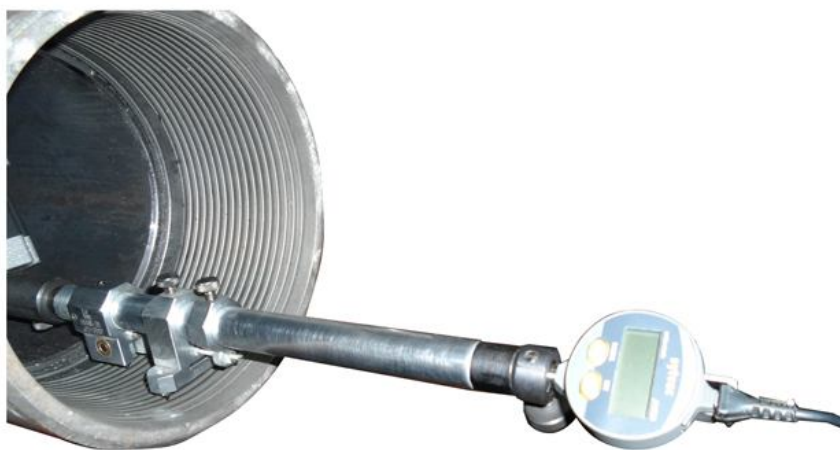
Рисунок Е.4 – Измерения шага резьбы прибором НИИК-100/31
