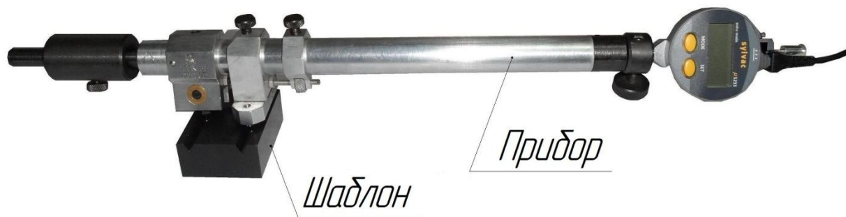
Рисунок Е.3 – Настройка прибора НИИК-100/31
