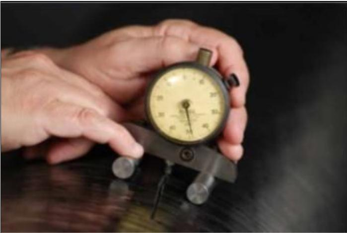
*a* – измерение глубины риски ручным способом
