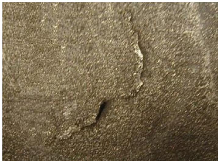
Рисунок А.6 – Характерный вид расслоения
