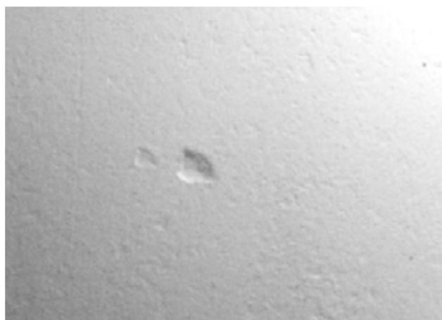
Рисунок А.17 – Точечная коррозия
