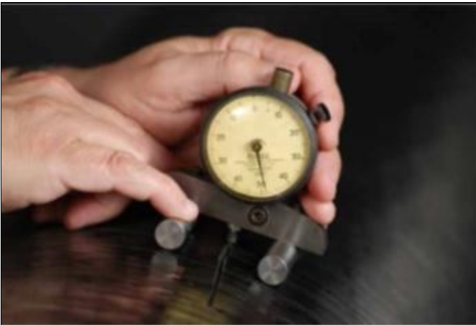
а – измерение глубины риски ручным способом
