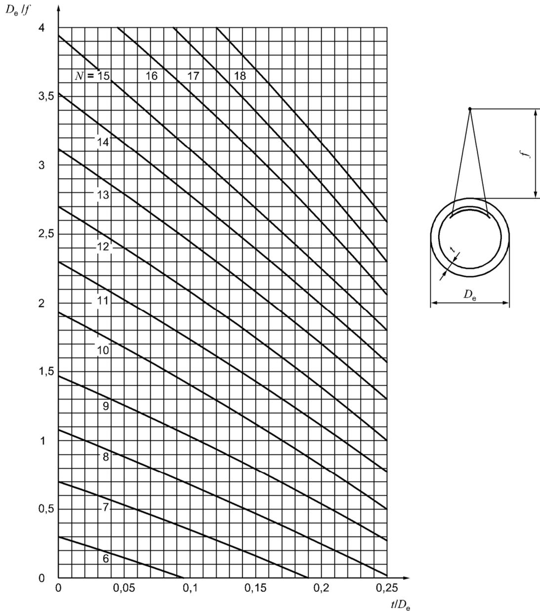
Рисунок А.3 – Минимальное число экспозиций  $N$  при просвечивании через одну стенку с источником снаружи, с максимальным допустимым увеличением просвечиваемой толщины  $\Delta t/t$  из-за косога направления излучения в проверяемой области равным 20% (класс А), как функция отношений  $t/D_e$  и  $D_e/f$
