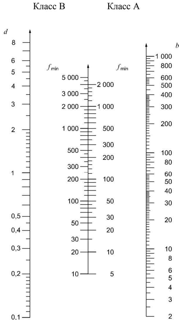
Рисунок 21 – Номограмма для определения минимального расстояния от источника излучения до контролируемого объекта,  $f_{\min}$ , в зависимости от расстояния от объекта контроля до пленки  $b$  и размера источника  $d$
