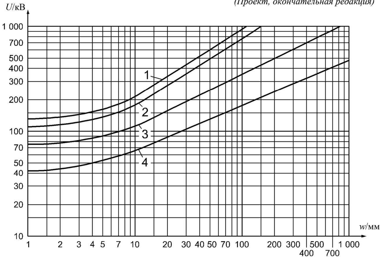
$U$  – напряжение на рентгеновской трубке;  $w$  – просвечиваемая толщина; 1 – медь/никель и сплавы на их основе; 2 – сталь; 3 – титан и сплавы на их основе; 4 – алюминий и сплавы на его основе
