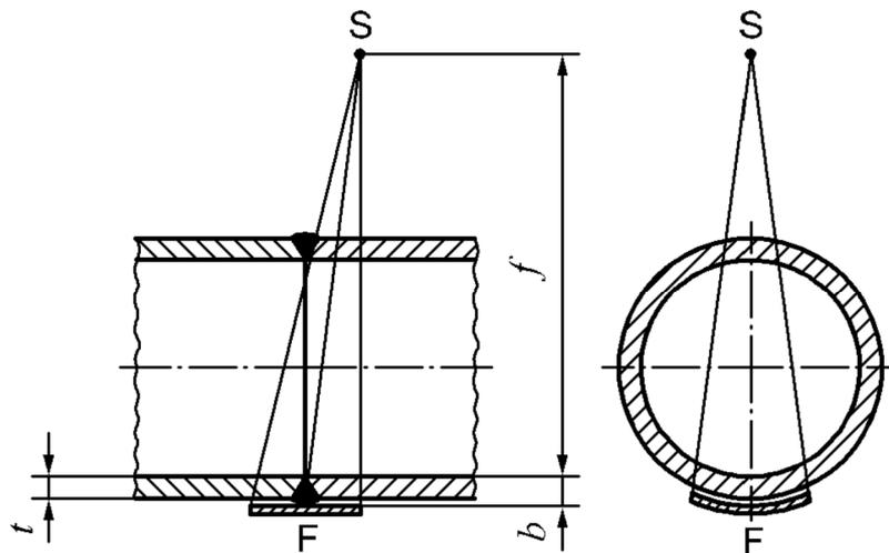
Рисунок 13 – Схема контроля изогнутых контролируемых объектов при просвечивании через две стенки (одно изображение) для контроля стенки, ближайшей к пленке; IQI должен располагаться со стороны пленки
