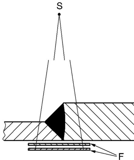
Рисунок 19 – Схема контроля с использованием нескольких пленок
