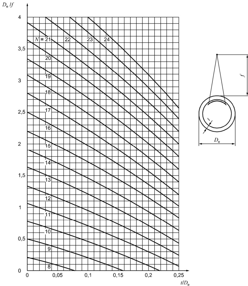
Рисунок А.1 – Минимальное число экспозиций  $N$  для просвечивания через одну стенку с источником снаружи, с максимальным допустимым увеличением просвечиваемой толщины  $\Delta t/t$  из-за косо направления излучения в проверяемой области равным 10% (класс В), в зависимости от отношений  $t/D_e$  и  $D_e/f$ .
