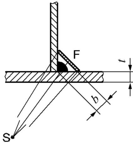
Рисунок 18 – Схема контроля при просвечивании угловых сварных швов
