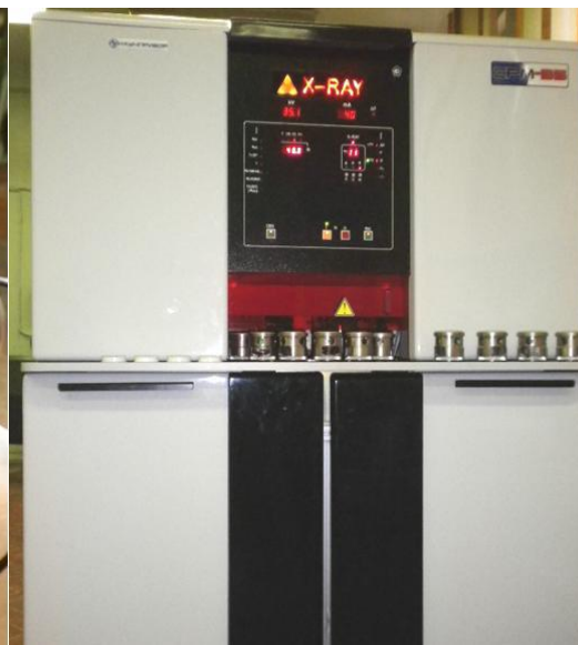
Рентгеноспектральный прибор нового поколения СРМ-35
